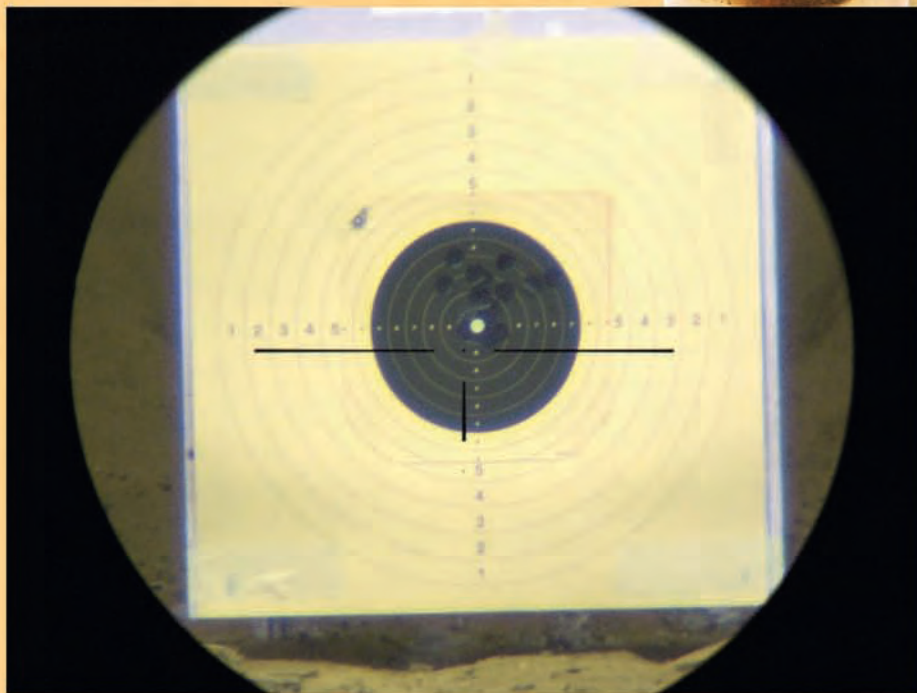
Schußleistung FN Sniper in .308 Winchester mit Munition mit unbeschichteten und BN beschichteten Geschossen
